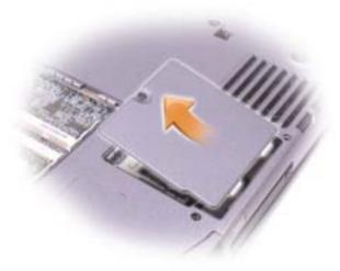
7 Ponga un dedo bajo la cubierta a la altura de la muesca y deslice hacia arriba la cubierta para abrirla.
