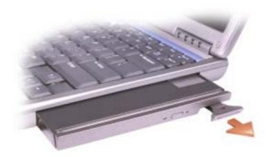
3 Inserte el nuevo dispositivo en el compartimento, empújelo hasta que se oiga un "clic" y presione el pasador de liberación del dispositivo de modo que quede al mismo nivel que el equipo.
