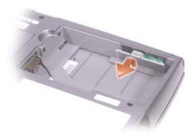
3 Tire de la batería de reserva para sacarla de su compartimento y desenchufe el cable de la batería de reserva del conector.
