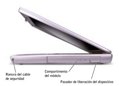
RANURA PARA CABLE DE SEGURIDAD — Sirve para conectar al equipo un dispositivo antirrobo disponible en el mercado. Para obtener más información, consulte las instrucciones que se incluyen con el dispositivo.
