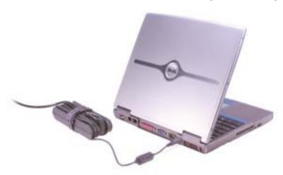
El adaptador de CA convierte la corriente alterna en la corriente continua que necesita el equipo. Puede conectar el adaptador de CA al equipo independientemente de si está encendido o apagado.
