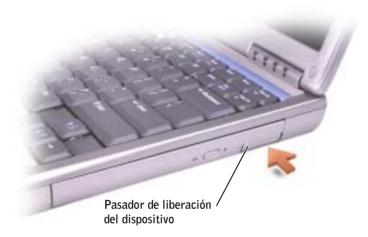
2 Tire del pasador de liberación para sacar el dispositivo del compartimento para módulos.
