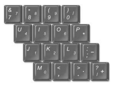
NOTA: Cuando se conecta al equipo un teclado o teclado numérico externo, se desactiva el teclado numérico.
