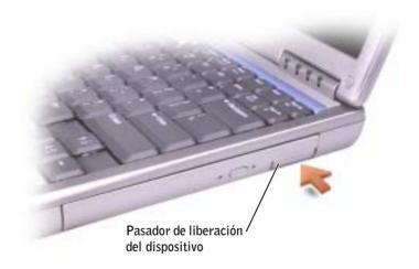
5 Tire del pasador de liberación para sacar el dispositivo del compartimento para módulos.
