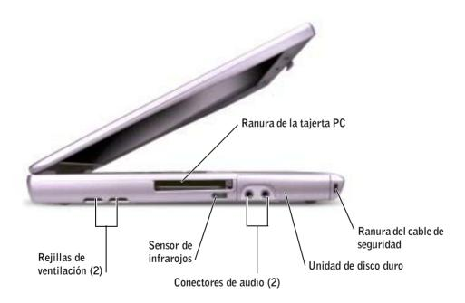
**REJILLAS DE VENTILACIÓN** — El equipo utiliza un ventilador interno para permitir que el aire circule a través de las rejillas y evitar así un sobrecalentamiento.
